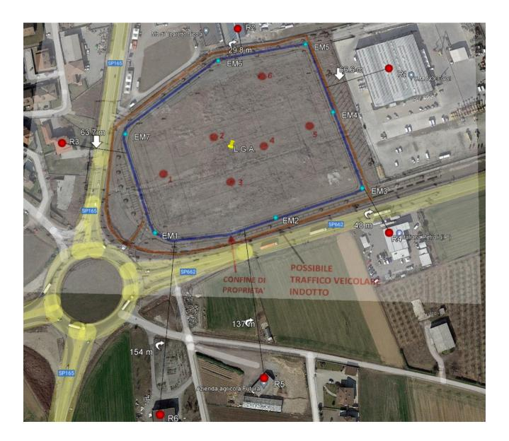
In R1, R2, R3, R4, R5, R6 sono state effettuate le misure fonometriche per la caratterizzazione del clima acustico.
