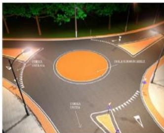
In area urbana vengono generalmente progettate rotonde con raggio esterno massimo di 12m, con isola centrale sormontabile.
