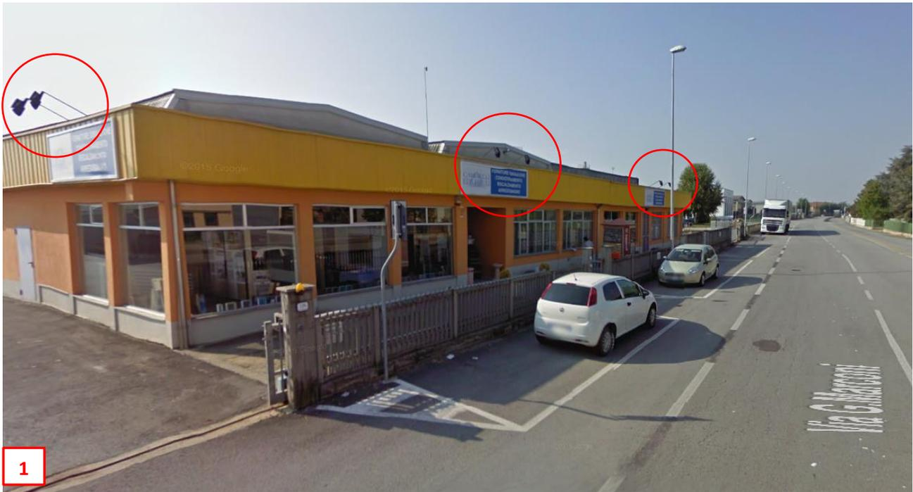
**Figura 41.** Zona industriale di Marene con illuminazione non conforme a causa dell'inadeguata inclinazione del supporto della lampada. Fonte: GOOGLE MAPS.
